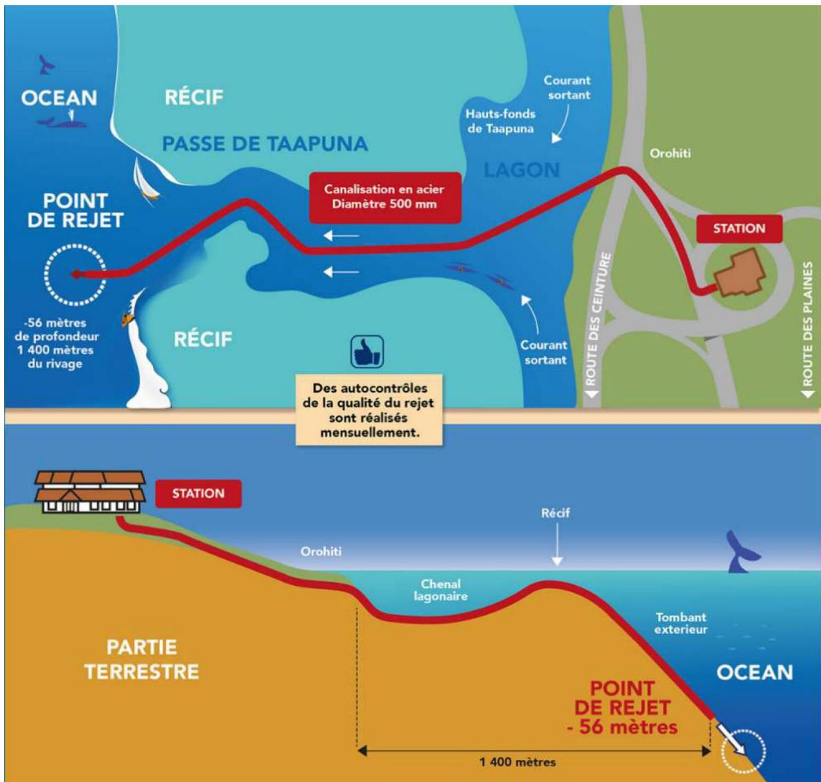
Figure 7 : Schéma explicatif de l'émissaire de la STEP
